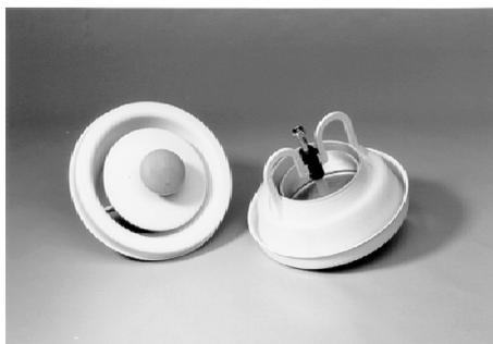
Диффузор для сауны **DSO-S** можно открыть и закрыть, просто нажав или потянув деревянную рукоятку. Максимальная степень открывания регулируется перемещением стопорного кольца. Минимальную степень открывания, которая предварительно установлена на 0 мм, можно регулировать, укорачивая пластиковую трубку. Максимальная рабочая температура +120°C. Для монтажа диффузора можно дополнительно заказать крепежное кольцо **DKK**.
