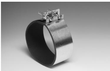
Хомут используется для соединения вентилятора с круглым воздуховодом того же диаметра и одновременно служит для гашения вибраций от вентилятора к воздуховоду. Преимущество данного типа хомута - это возможность легко отсоединить вентилятор, снять его для ремонта, чистки или других целей.
