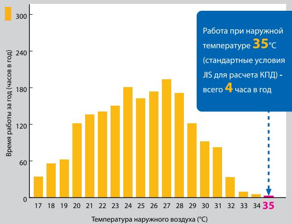
Работа при наружной температуре **35°C**
