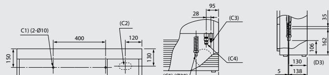
Схема подключения труб
