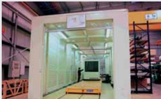
Все чиллеры проходят заводские испытания, в ходе которых они проверяются путем имитации фактических условий эксплуатации.
