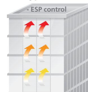
Залегание горячего слоя воздуха вдоль фасада
